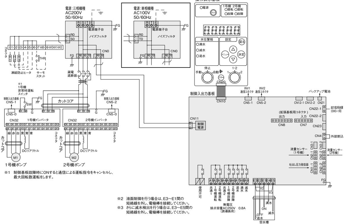
※1 制御基板故障時にONすると通信による運転指令をキャンセルし、最大回転数運転をします。
