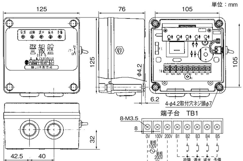
③配線距離250m以内、1.25mm<sup>2</sup>CV線(最大2mm<sup>2</sup>)
