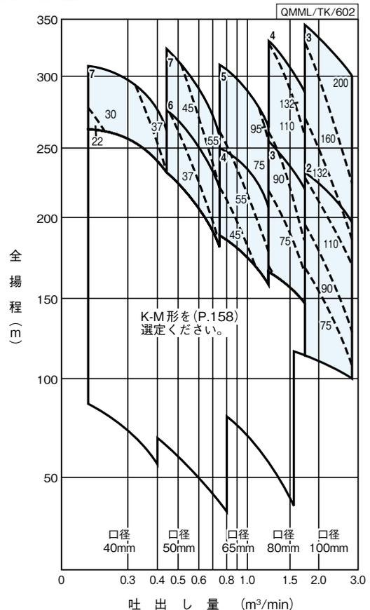
図中の太字はケーシング段数、細字はモータのkWを表します。
